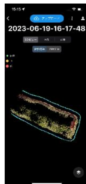
Fix している状態で撮影できているため、赤や黄色の点が軌跡に存在しない。
