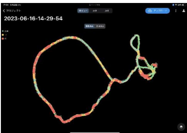
Fix できていなかった状態で撮影したため、赤や黄色の点が軌跡に存在している。
