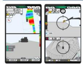
オペレーターはICTモニターで設計データを確認
