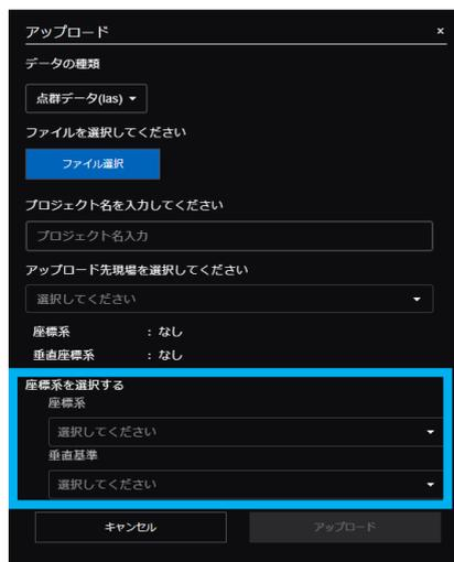
LandXML 形式のファイルをアップロードした場合は、AR 用データ色も選択ができます。データのアップロードが完了したら、下記の様な AR 専用プロジェクトが作成されます。AR 専用プロジェクトをタップすると、指定した座標系や、AR 専用ファイルにアップロードしたファイル名を表示できます。また、その画面で「削除」ボタンをクリックする事で、アップロードしたデータの削除もできます。
