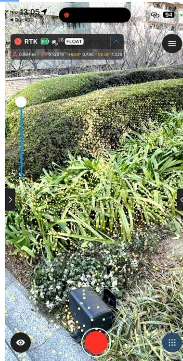
「RTK デバイス接続直後」はまだ目の前に読み込んだデータ（点群データ and/or 設計データ）が表示されますが、ステータスが「FIX」になった状態で周辺を少し動き回ると読み込んだデータが座標系にそった位置に表示されます。
