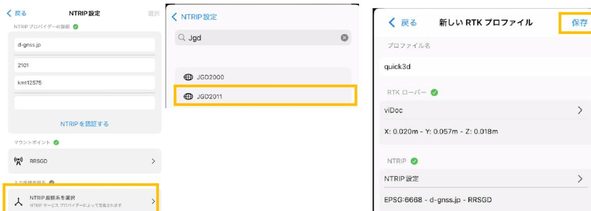
9. 8の手順まで実施完了したら、右上の接続を選択します。「接続」クリック後、撮影画面に移行します。左上の表示が“RTK Fixed”と表示されていれば、補正情報を利用した撮影が可能となります。“DGNSSのみ”や“RTK Float”の表示の場合、正確な補正情報を取得できず、作成される点群の精度に影響が出てしまう為ご注意ください。
