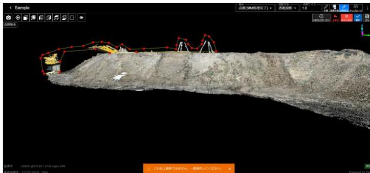
5. または、4 の手順で確定をクリックした後、“選択範囲を反転する”機能を利用して、選択した範囲以外の点群が除去対象とすることができます。つまり、範囲選択時に、残したい部分以外の割合が大きい場合は、あらかじめ残したい部分だけを選択して、“選択範囲を反転する”にチェックをいれることで、効率よく点群の除去を行うことも可能です。
