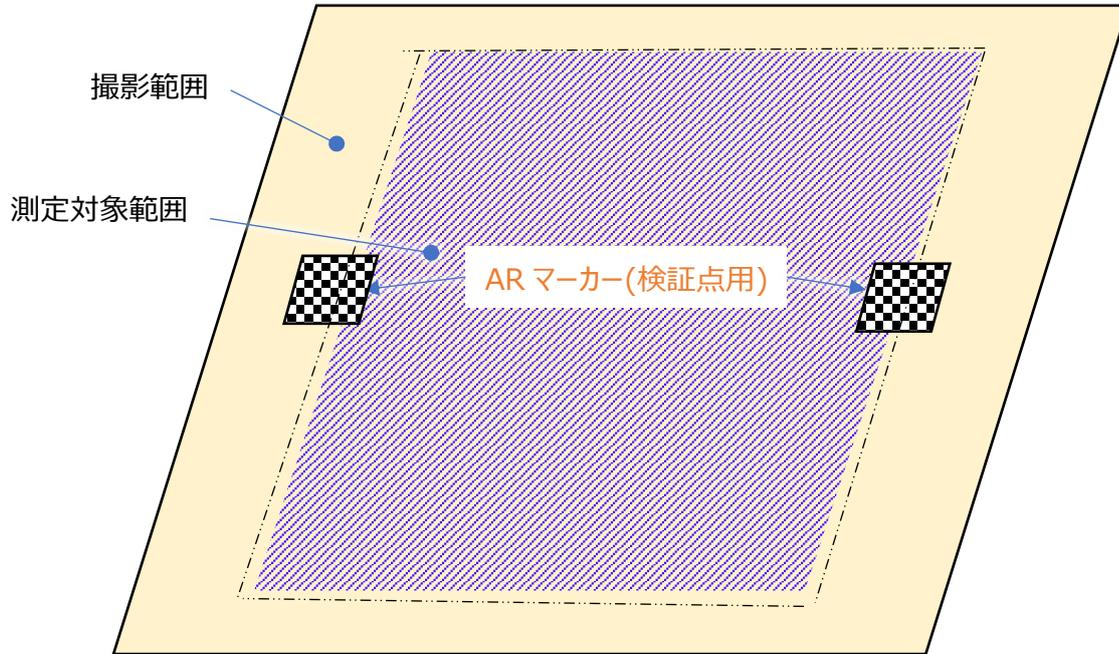
※1 RTK デバイス使用時は、以下の専用 AR マーカーを用いて撮影を行います。
