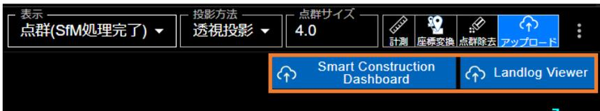
3. Smart Construction Dashboard にアップロードする場合、アップロード対象の点群(3-1)、ファイル形式(3-2)、アップロード時の穴補間 (3-3) を選択する。Landlog Viewer にアップロードする場合は座標系(3-4)を選択する。
