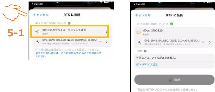
6. 次に RTK ローバー設定を行います。“設定 > RTK デバイス設定”から、“新しい RTK プロファイル”を選択してください。その後、プロフィール名を入力後、“RTK ローバー”を選択ください。viDoc の絵を選択し、“viDoc カメラオフセット”がご利用のケースに合うものを選択下さい。
