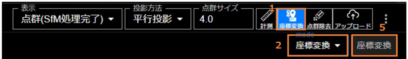
3. 「4.2 AR マーカーの設置と位置座標測定 (RTK デバイス未使用時)」でインポートした座標と、点群内の標定点位置を紐づける。
