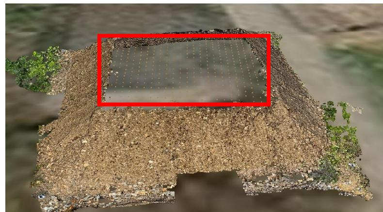
設定を有効にすることで、穴補間が行われて、Smart Construction Dashboard上で体積計算が可能となります
