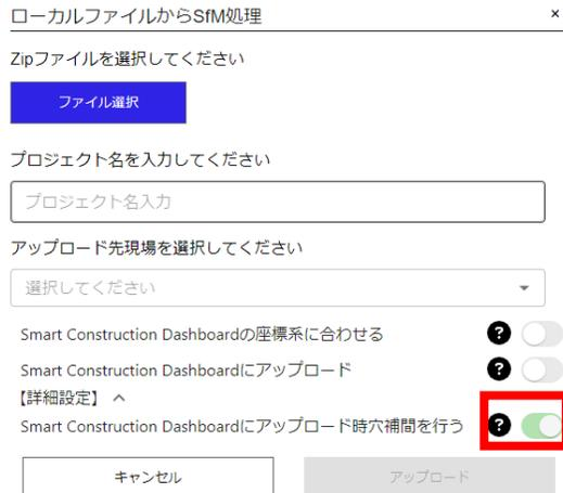
Smart Construction Dashboardに点群をアップロードした際に、以下のような穴補間が実施されます。
