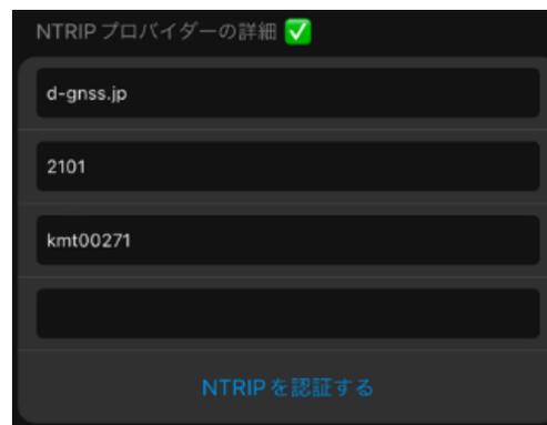
8. ご利用いただく Ntrip プロバイダ※に応じたマウントポイントと、それに応じた Ntrip 座標系を選択します。
