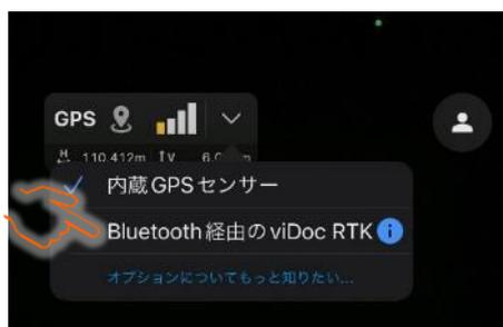
5. “RTK BLUE TOOTH デバイス”の選択から、接続機器(※)を選択します。
