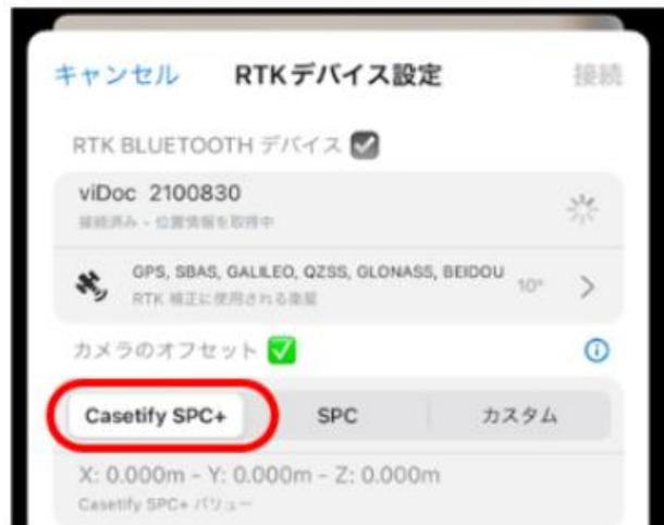
PIX4Dcatch アプリを直接立ち上げて撮影画面を開いてしまうと、「カメラのオフセット」の一番左側の表示が「SPC+」になっており、「Casetify SPC+」が表示されません。「Casetify SPC+」を表示するには Smart Construction Quick3D アプリから撮影画面に入っていく必要があります。
