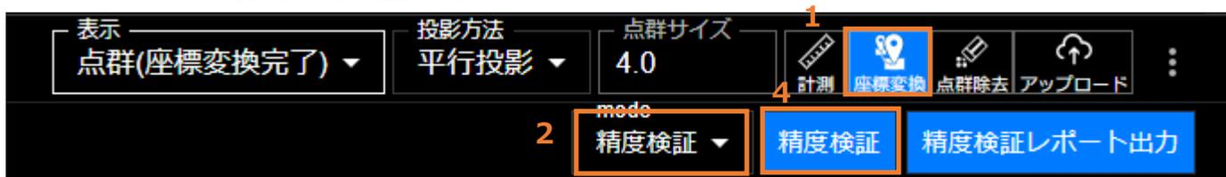
3. 「4.2 AR マーカーの設置と位置座標測定 (RTK デバイス未使用時)」でインポートした座標と、点群内の検証点位置を紐づける。
