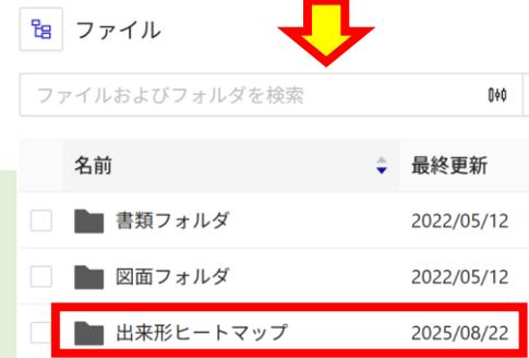
出来形ヒートマップを作成する「LASファイル」と「LandXMLファイル」をドラッグ&ドロップしてアップロード
